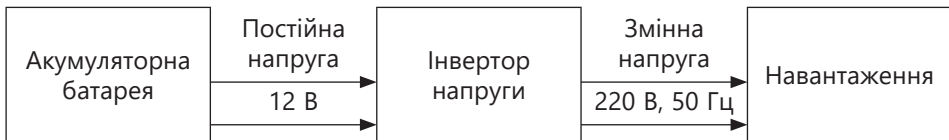
Рис. 11.18. Спрощена структура інвертора напруги
