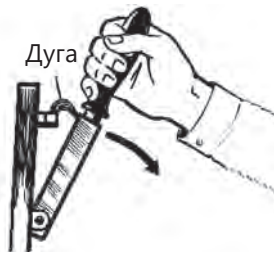
Рис. 3.7. Приклад виникнення самоіндукції (дуги)
