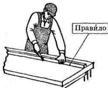
*Рис. 5. Прорезка листа гипсокартона*
