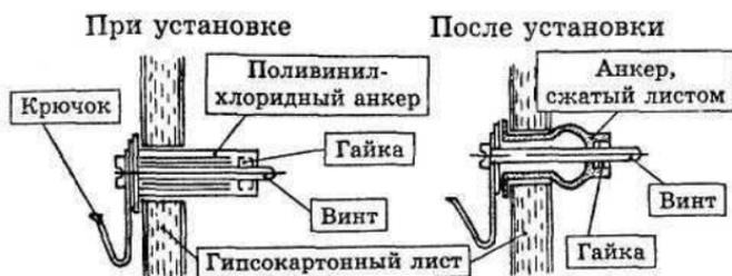
Рис. 21. Крючки для крепления в гипсокартонных перегородках
