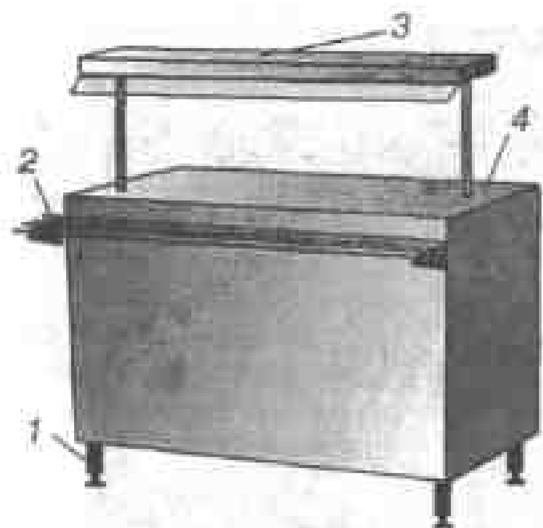
Рис. 11.21. Нейтральний прилавок: 1 — опора; 2 — бар'єр; 3 — полиця; 4 — стіл
